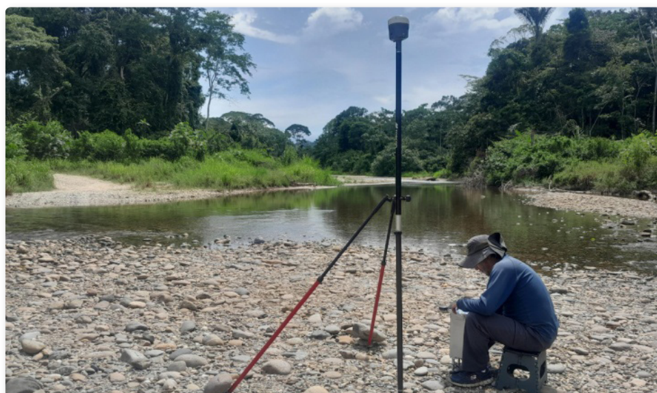
Figura 26. Técnico del proceso de Geodesia realizando la densificación gravimétrica - sector Macas -Taisha
