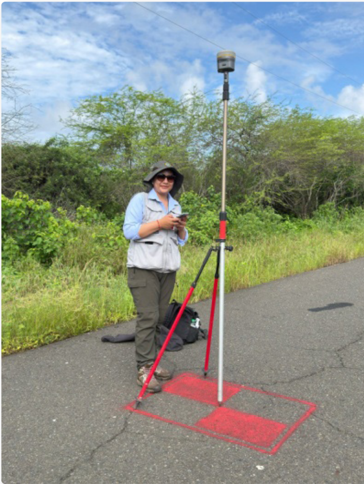
Figura 20. Personal técnico obteniendo información GNSS (Puntos de Apoyo Fotogramétrico para Carta Nacional)
