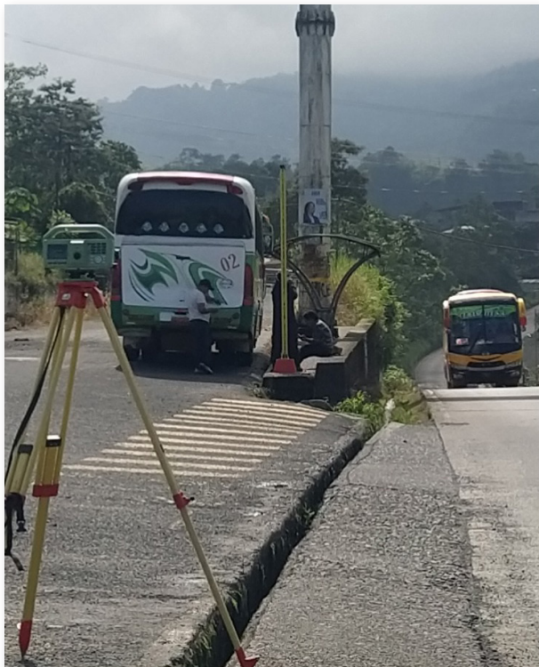
Figura 23. Técnico del proceso de Geodesia realizando la nivelación geométrica en los terrenos de la empresa CHINA HARBOUR ENGINEERING COMPANY
