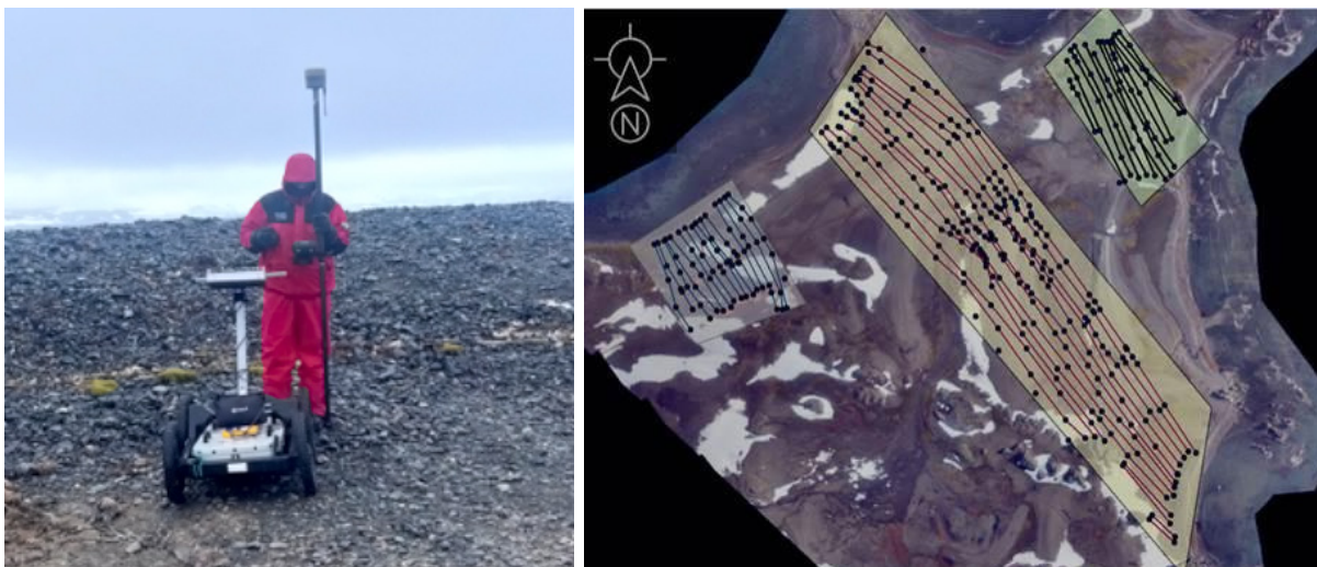
Figura 62. Ejecución del trabajo con el Georadar y sus líneas de estudio definidas
