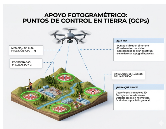
Figura 1. Distribución técnica de GCP para apoyo fotogramétrico. Fuente: Proceso de Geodesia, 2026.
