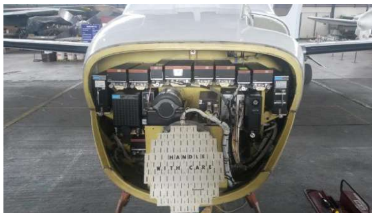
Figura 2. Compartimiento de aviónica actual del avión CESSNA 550 CITATION II IGM-628.
